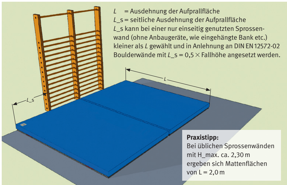
Abbildung 7: Fallraum einer Sprossenwand
