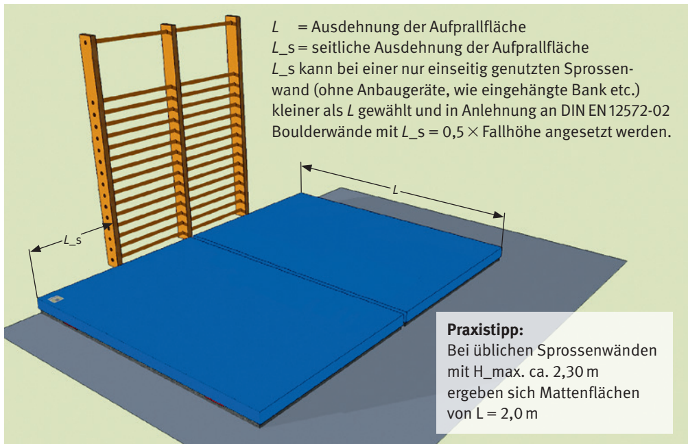
Abbildung 7: Fallraum einer Sprossenwand
