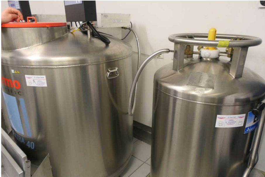
Kühltanks für die Kühlung der (resistenten) Krebszellen
