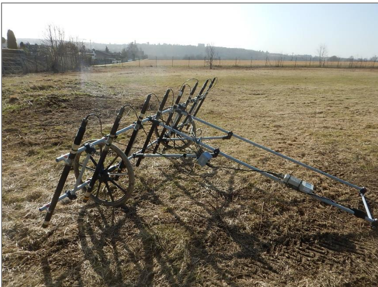
Foto: Mehrkanaliges Fluxgate-Magnetometer mit Sonden der Fa. Sensys auf der zu untersuchenden Fläche
