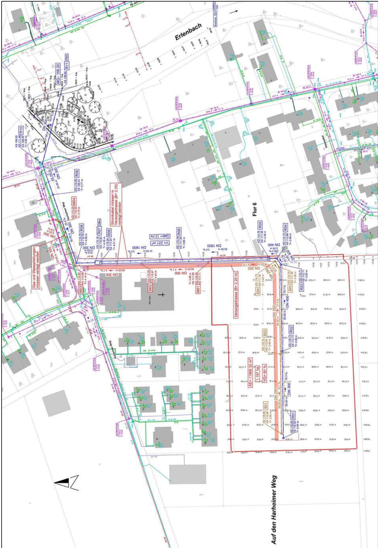
Abbildung 21: Lageplan Entwässerung Quelle: Ingenieurbüro Hartwig, Wiesbaden
