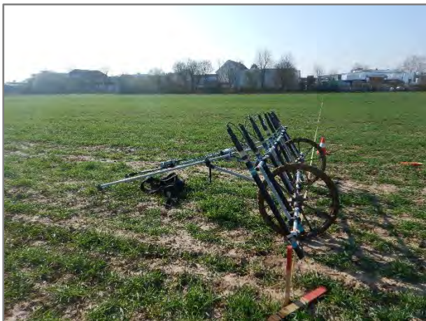
Foto: Mehrkanaliges Fluxgate-Magnetometer mit Sonden der Fa. Sensys auf der zu untersuchenden Fläche
