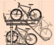
Voraussetzung: Durchgangshöhe der Überdachung anheben auf ca. 2700 mm. Die Verwendung von ORION-Doppelstockparkern ermöglicht die Unterbringung der maximalen Anzahl an Rädern unter vorhandener Dachfläche! Infos zum Doppelstockparker finden Sie auf Seite 614.
