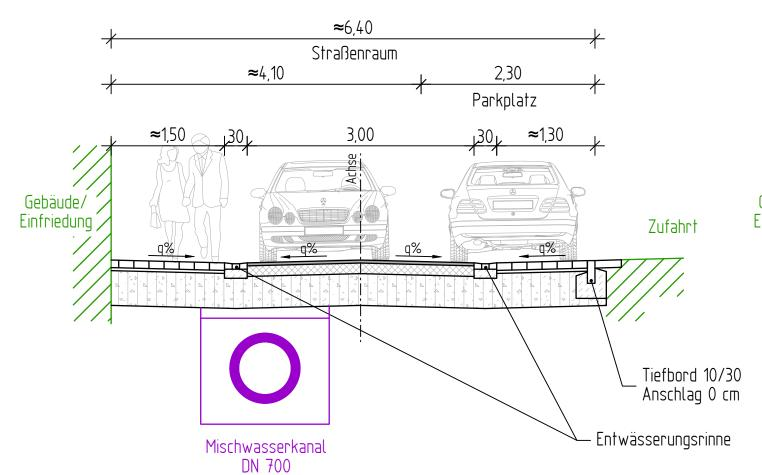
Regelquerschnitt Variante 2
