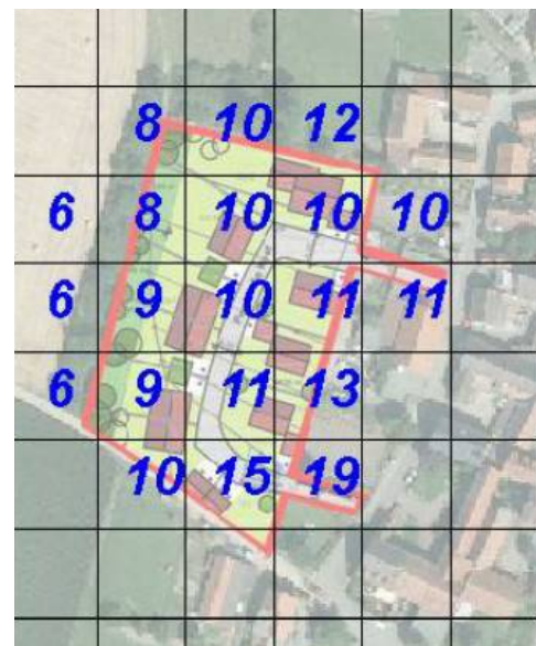
Abbildung: Auszug aus dem Geruchsgutachten (Anlage 3 zum Bebauungsplan) - Belästigungsrelevante Kenngröße IG 6 bei einer Auflösung von 25 m. Der Immissionswert für Wohn- und Mischgebiete beträgt 10%, für Gewerbegebiete 15%.
