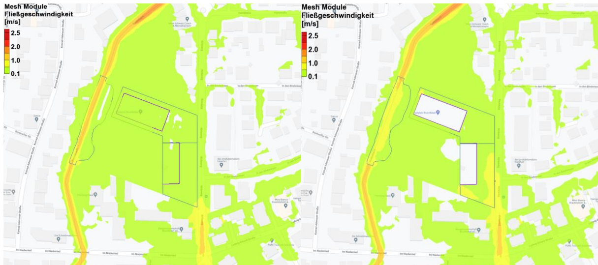
Abbildung 8-3: Fließgeschwindigkeiten des Referenz- (links) und Planzustands (rechts)
