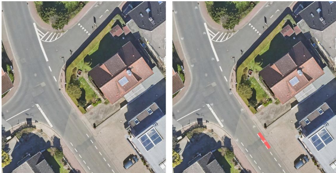
Abbildung 37: Systemskizze Bestand und Empfehlung Bahnhofstr. / Seewiesenring
