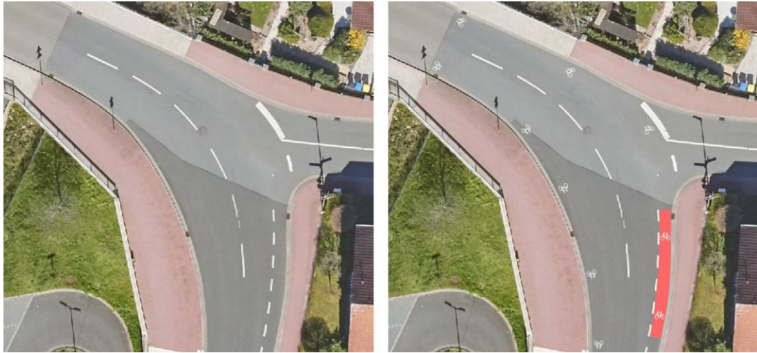
Abbildung 36: Systemskizze Bestand und Empfehlung Bahnhofstr. / Roßdorfer Straße
