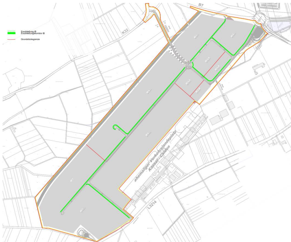
Abbildung 8 Quartier mit Kennzeichnung des Leitungskorridors auf Privatgrund
