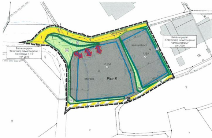
Abbildung 2 Baugrenze auf Flst. 23 im Gefahrenbereich der Waldfläche auf Flst. 23 u. 25/6 (Gefahrenbereich mit violetten Doppelpfeilen markiert)
