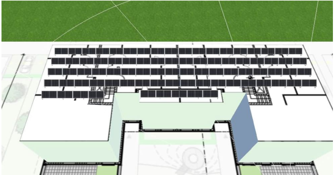
Abbildung 11: Konzept Wohnhaus 3 Dachbelegung PV-Anlage
