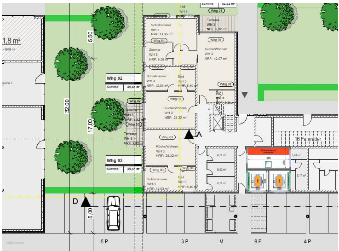
Abbildung 10: Möglicher Standort Technikfläche Trafos und MS-Anlage
