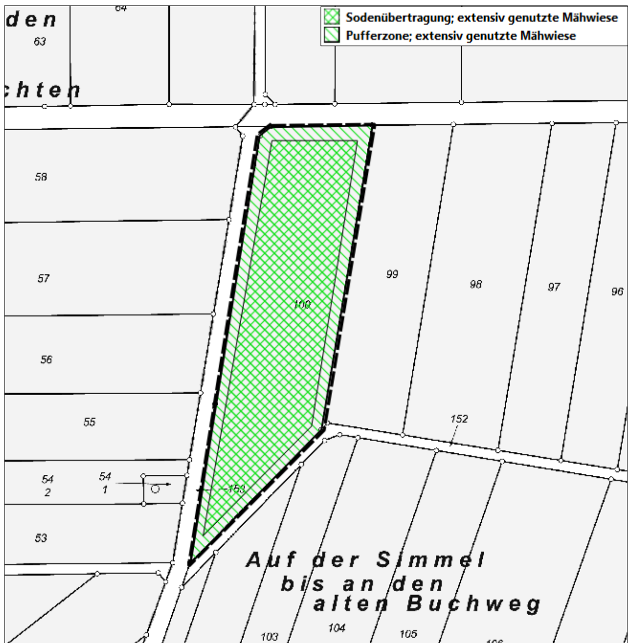
Abbildung 22: Liegenschaftskataster mit der Ausgleichsfläche auf Flurstück 100. Grün kariert der Bereich der Fläche für den Auftrag des LRT 6510, in grün die randliche Pufferzone.
