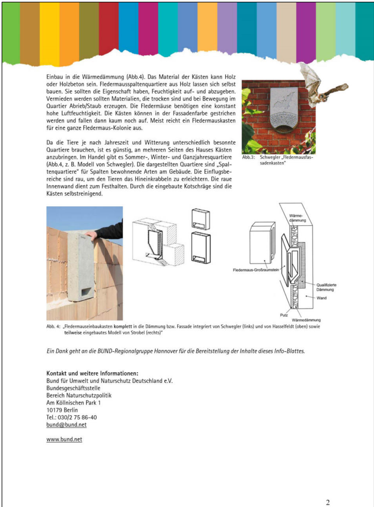
Abb. 11: Einbau von Fledermausquartieren in die Wärmedämmung (2).
