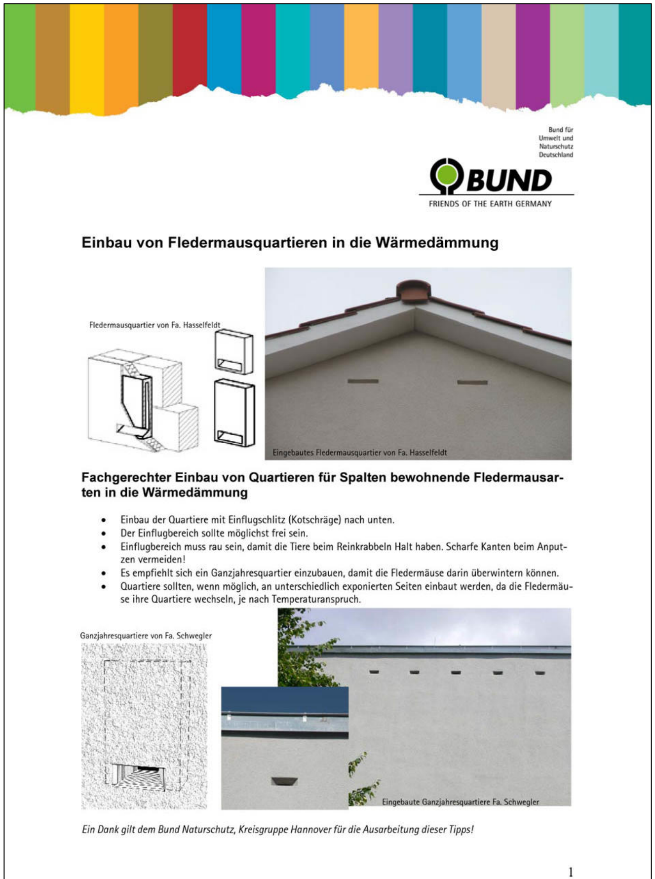
Abb. 10: Einbau von Fledermausquartieren in die Wärmedämmung (1).
