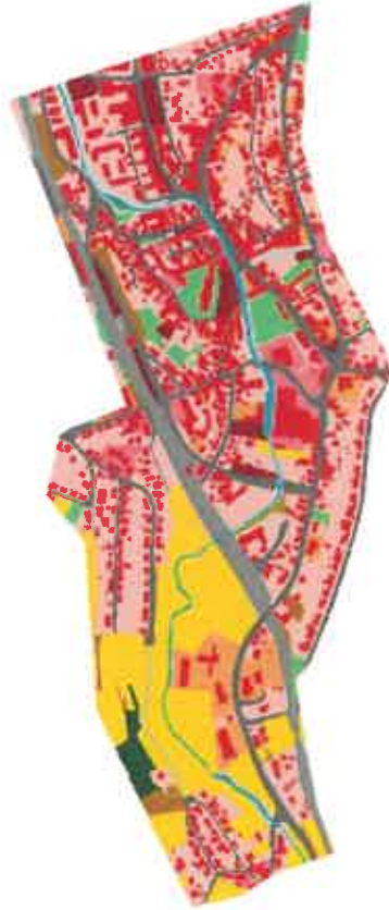
Abbildung 3: festgelegte Manning-Strickler Rauheitsbeiwerte ( K_{St} ) für den Modellbereich
