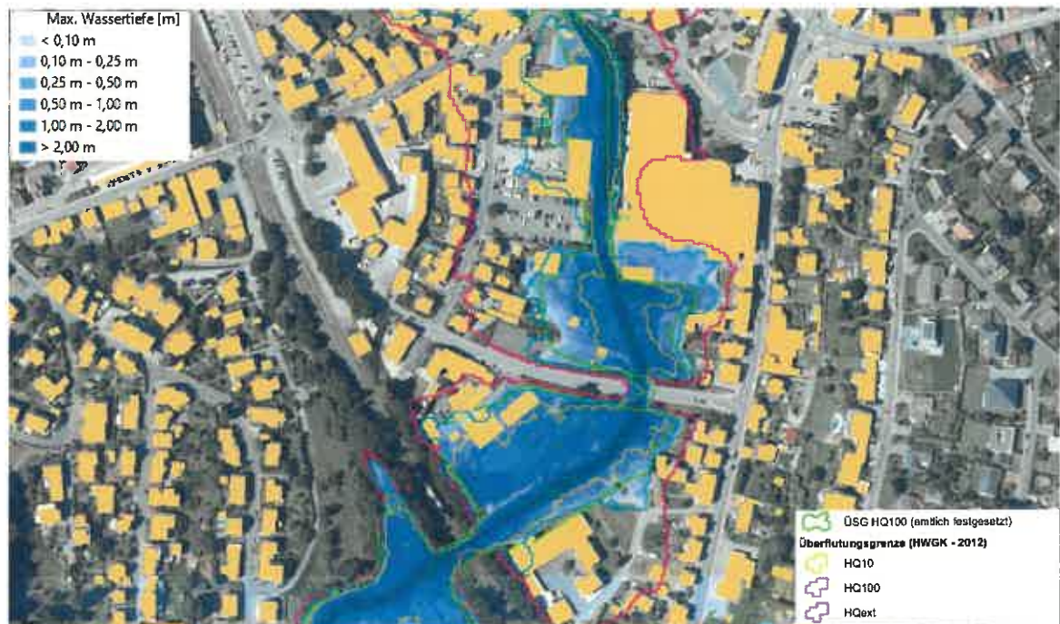
Abbildung 4: Max. Wassertiefen beim HQ100-Ereignis im Istzustand
