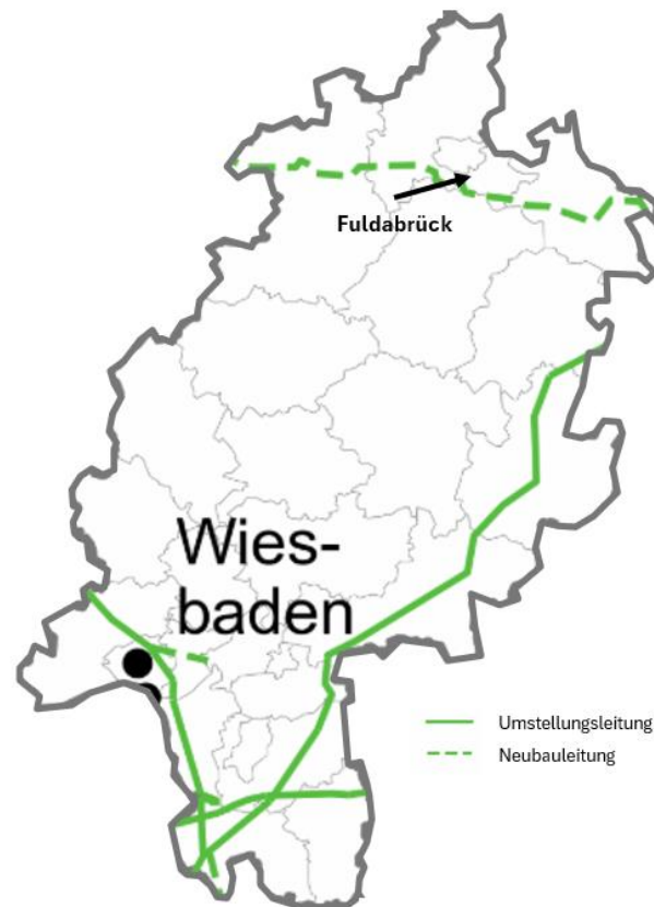
Abbildung 4-18: Geplantes Wasserstoffnetz für das Jahr 2032 - Hessen
