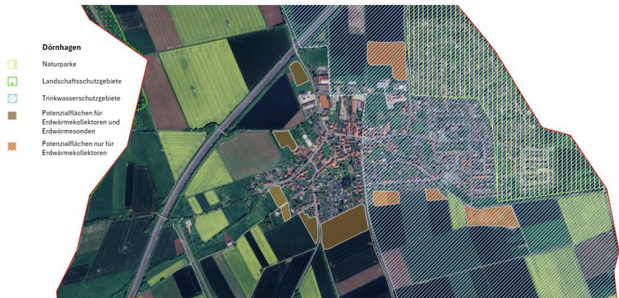
Abbildung 4-9: Potenzialflächen für oberflächennahe Geothermie – Dörnhausen
