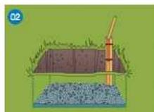
**02** Der Zollstock wird mit einem Klebeband an der Holzplatte befestigt und diese in den Boden der Grube gesteckt.
