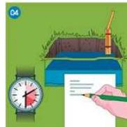
**04** Ist die Vorwässerung beendet, kann die eigentliche Messung stattfinden. Die Grube wird mit Wasser gefüllt. Wasserstandshöhe und Uhrzeit werden notiert. Am Ende der Messung werden wieder Uhrzeit und Wasserstand notiert. Es sollten drei Messungen nacheinander durchgeführt werden. Bei Bedarf wird die Grube zwischen zwei Messungen wieder mit Wasser aufgefüllt.
