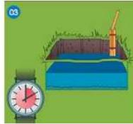
**03** Weil ein trockener Boden das Wasser schneller aufnimmt als ein bereits feuchter, muss die Grube etwa eine Stunde lang vorgewässert werden. Erst dann wird die Versickerungsleistung konstant und man kann mit praxisgerechten Ergebnissen rechnen. In dieser Phase ist wichtig: Die Grube darf während der Vorwässerung nicht trocken fallen!
