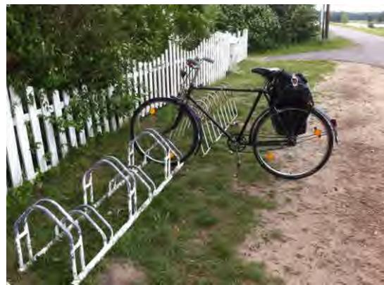
Abbildung 2: Typ Felgenklemmer (ungeeignet)
