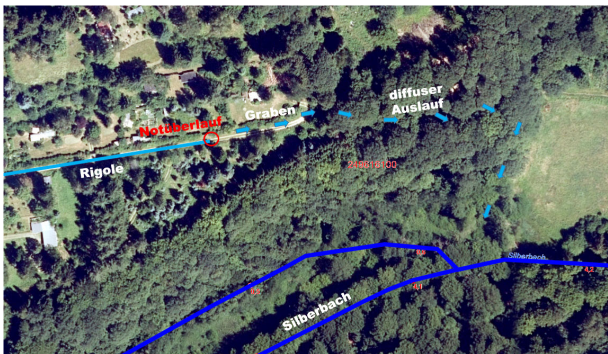
Abbildung 4: Skizze Notentlastung und Auslauf
