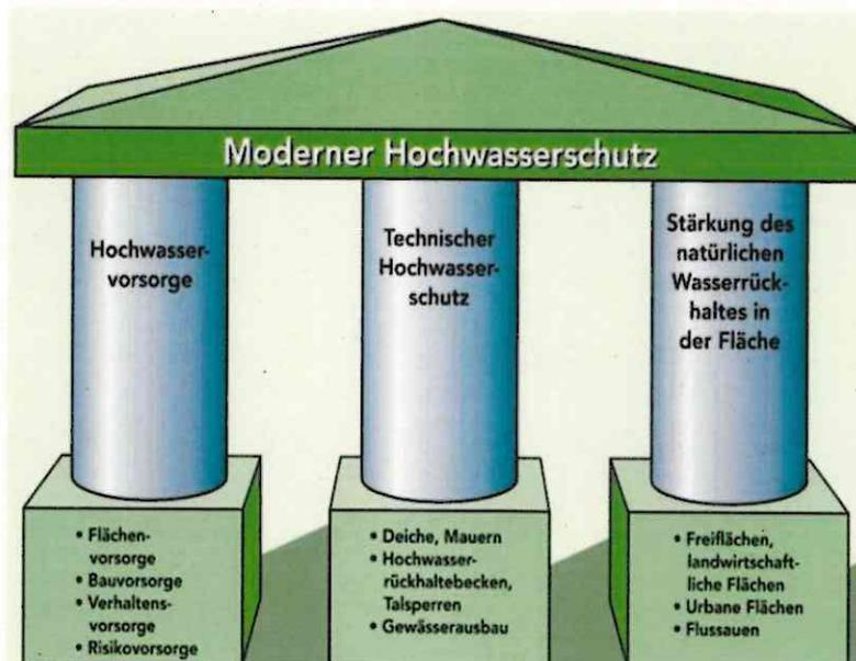
Die drei Säulen gelten als Ziele eines nachhaltigen Gewässerabflusses und Hochwasserschutzes. Sie verbinden (Hoch-)Wasserfluss und Hochwasservorsorge, den technischen Hochwasserschutz sowie die Stärkung des natürlichen Wasserrückhaltes in der Fläche und bilden die Basis für die Arbeit des Hochwasserzweckverbandes.
