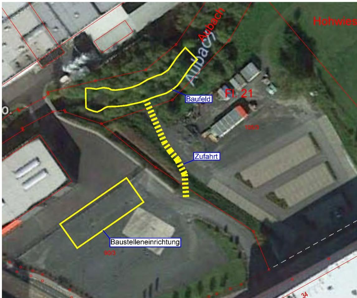
**Abb.11:** Standort der Baustelleneinrichtung und schematische Darstellung des Baufeldes und der vorgesehenen Baustraße mit Baustelleneinrichtungsfläche
