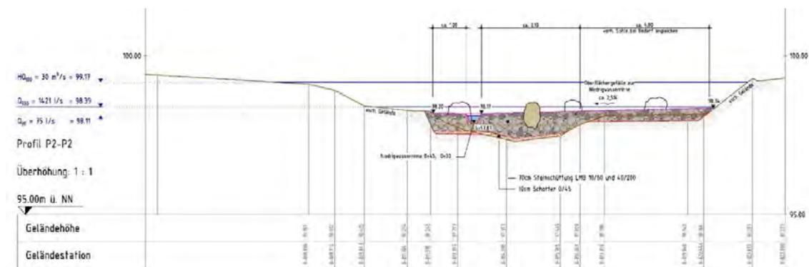
Abb. 14: Beispielhafter Querschnitt P2 der Rauhen Gleite
