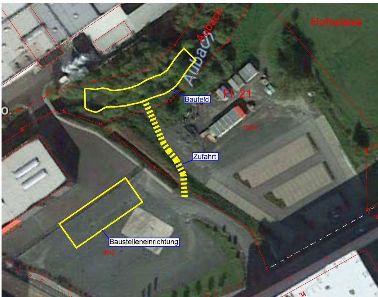
Abb. 27: Schematische Darstellung des Baufeldes mit Baustellenzufahrt und der Baustelleneinrichtungsfläche
