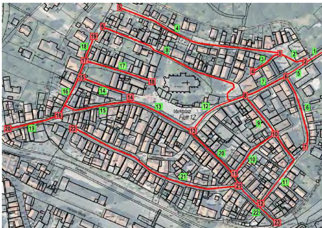
Abbildung 41: Lageplanskizze des Nahwärmenetzes der Altstadt
