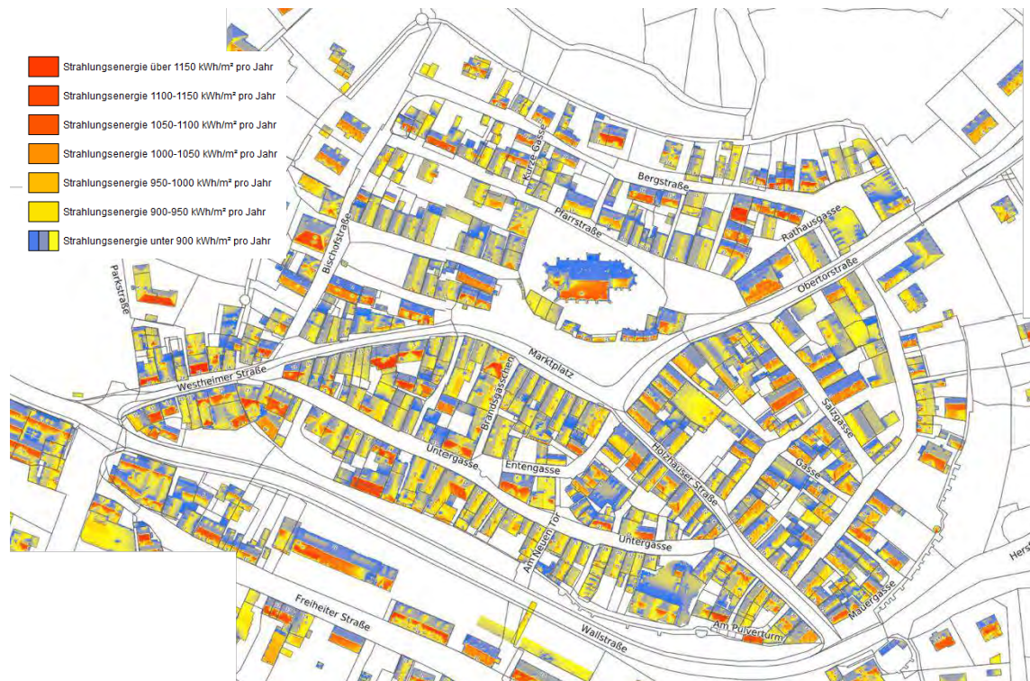
Abbildung 40: Dachflächen für PV-Anlagen Quelle: Solarkataster Hessen
