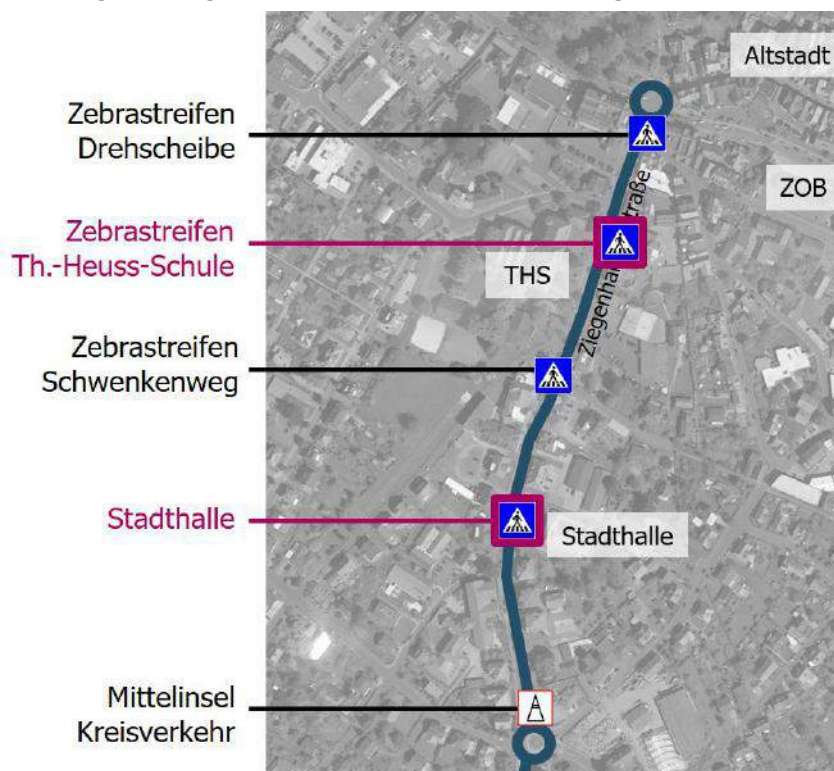
Abbildung 78: Anlage zusätzliche Zebrastreifen in der Ziegenhainer Straße
