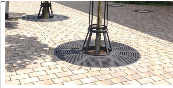
Baumrost Material: Gusseisen Radialdesign Aussen D: 150cm, Innen D: 60 cm inkl. Rahmen
