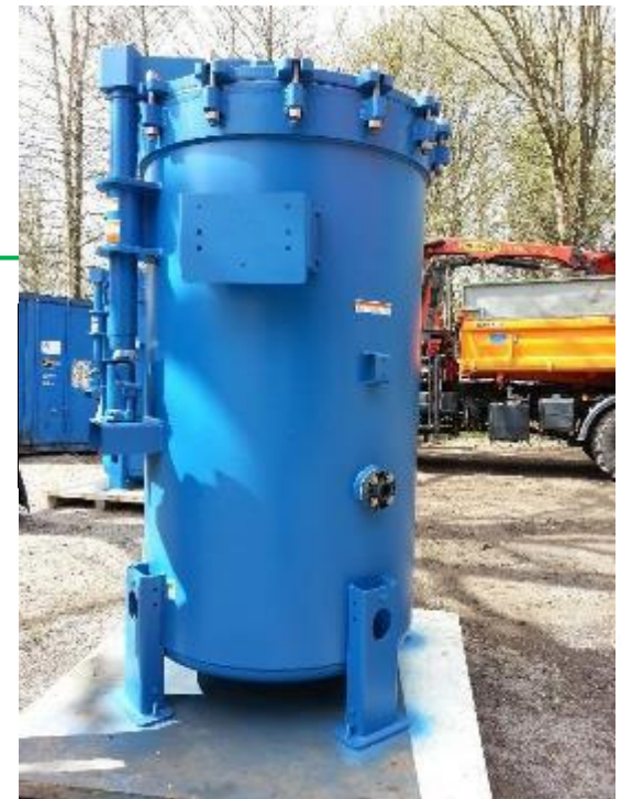
System Anschwemmfilter (Defender) Sportbecken im Freibad
