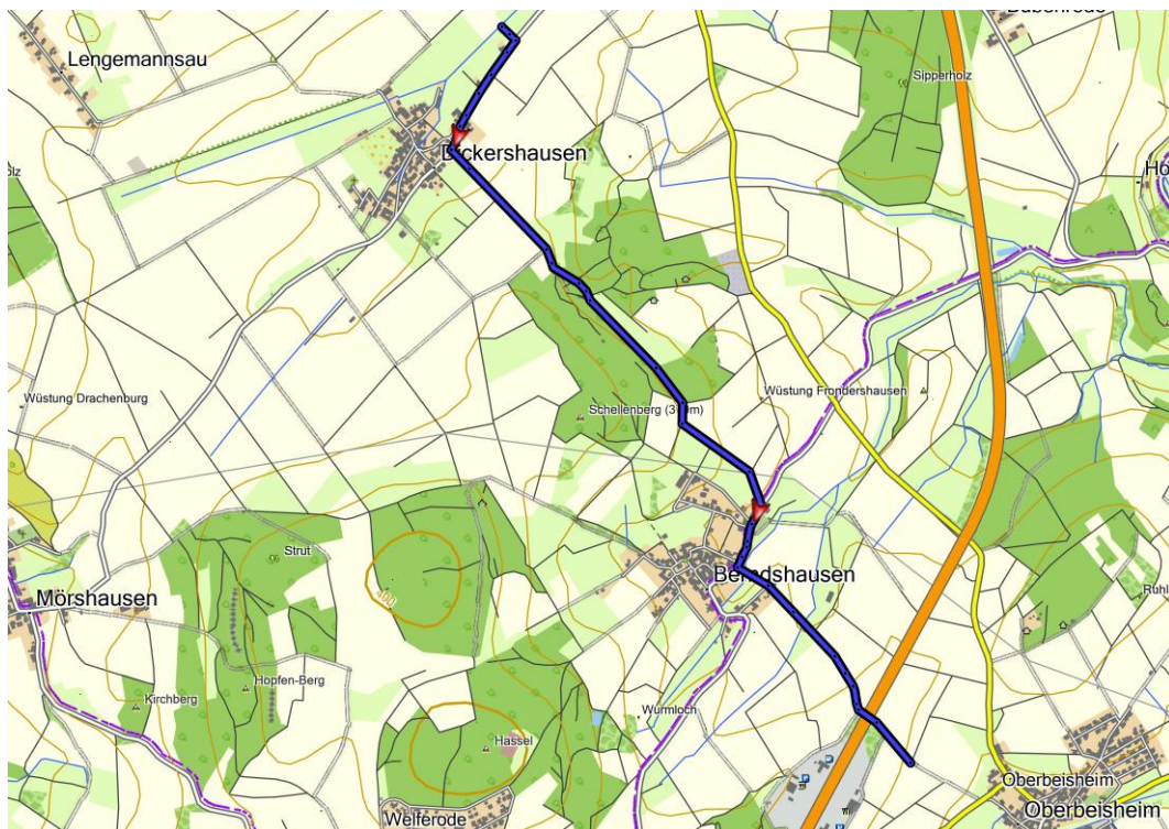
Abbildung 8: Druckleitung Dickershausen – Übergabepunkt – Lageplanskizze
