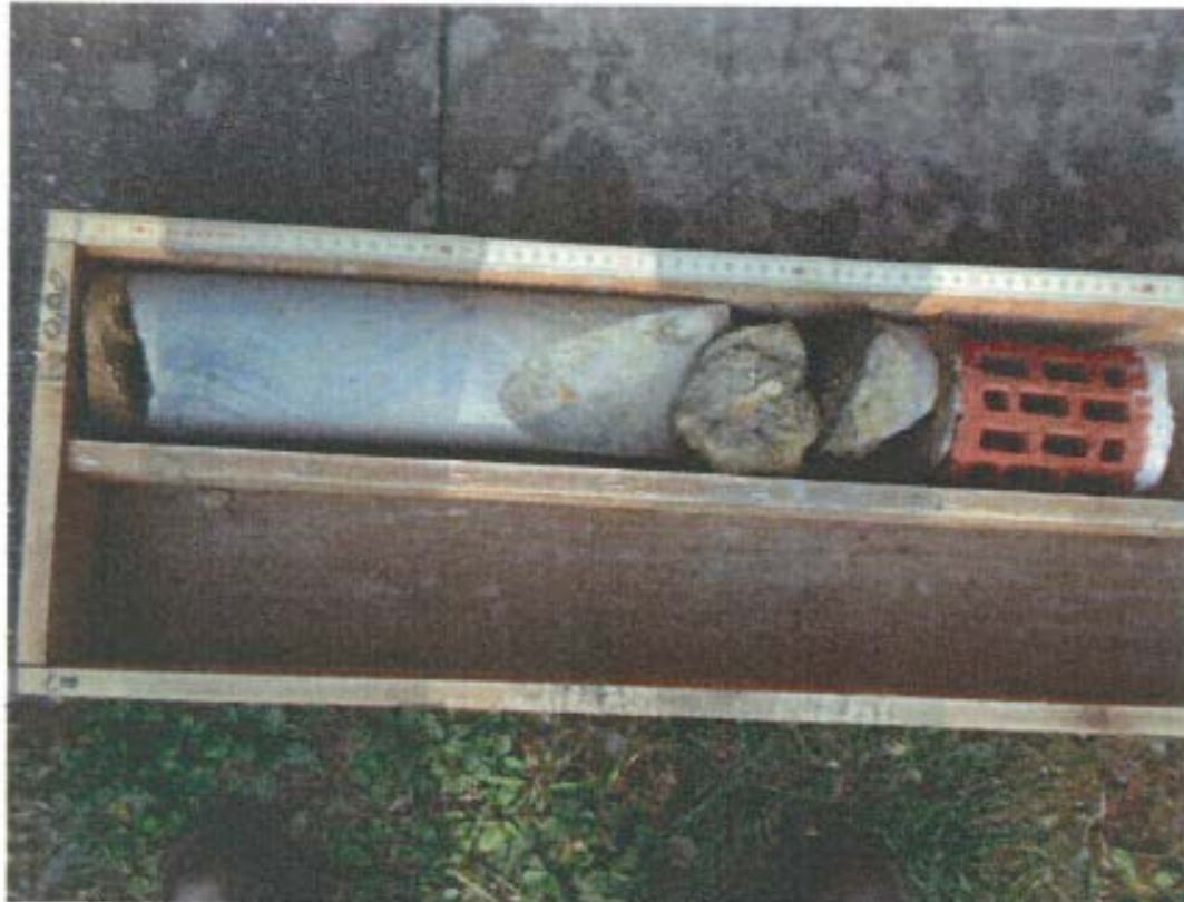
Bohrkern H- KB I unter der Südostgiebelwand Haus 8b (Remise)
