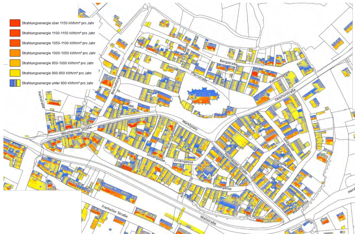
Abbildung 40: Dachflächen für PV-Anlagen
