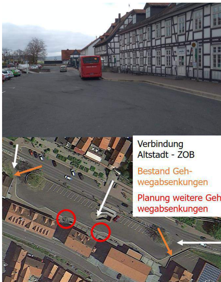
Abbildung 87: Ergänzende Gehwegabsenkungen am ZOB
