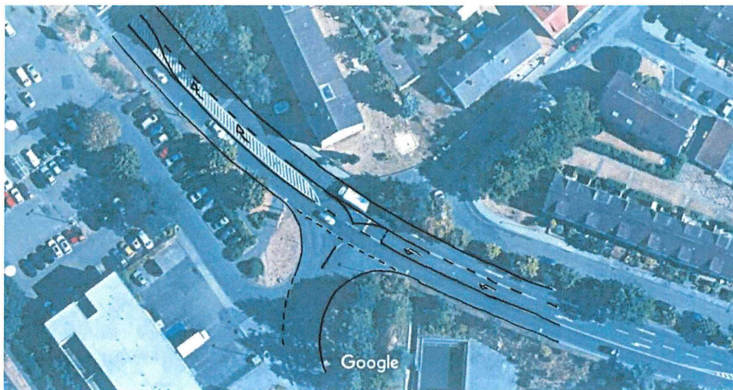
Abb.: Schemaskizze innenliegender Linksabbieger, Quelle Köhler & Leutwein, Erläuterungsbericht, Anlage 1
