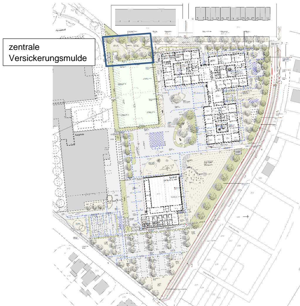
Abbildung 9: Auszug aus dem Konzept zum Neubau der Karl-Treutel-schule mit Lagekennzeichnung der Mulden-Rigolen-Systeme sowie einer zentralen Versickerungsmulde im nördlichen Bereich des Plangebietes. (Versickerungsmulde = blau umrahmt, Zuleitungen = blau) (unmaßstäblich)
