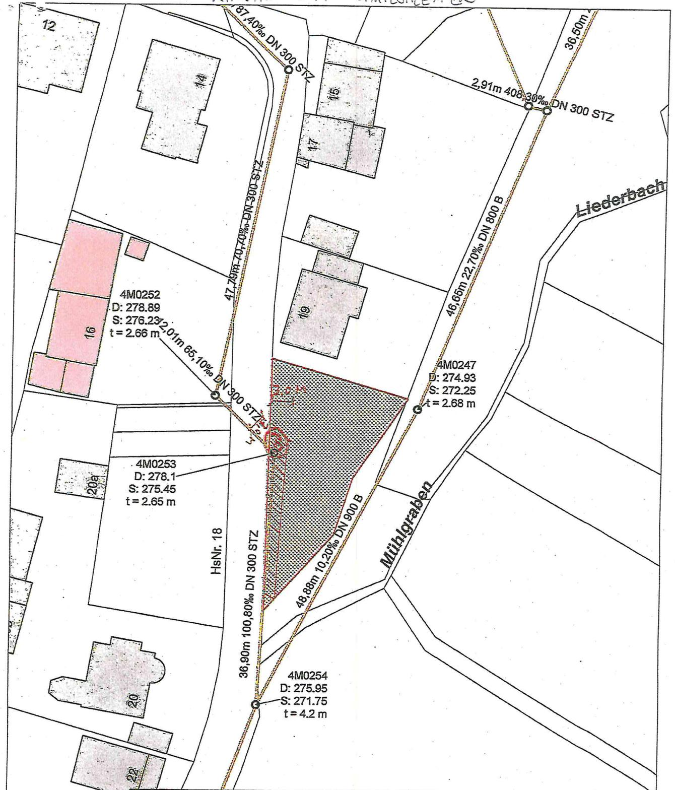
**Lageplan: Schutzstreifen Kanal Flur 4, Flurstück 32/4 Schneidhain**
