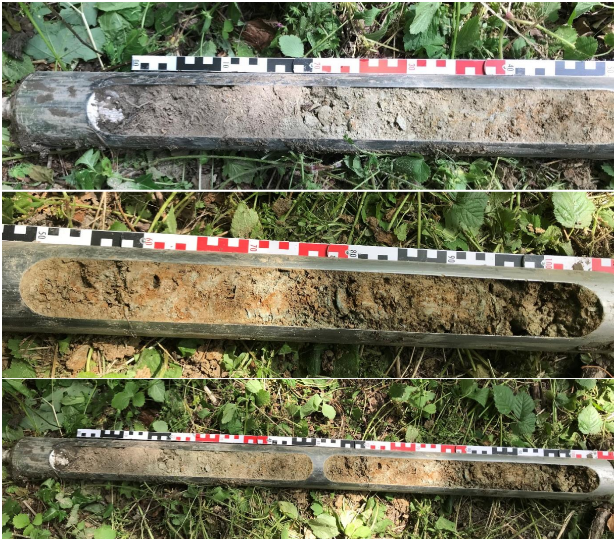
RK C 1-2 – Braunerde-Hangpseudogley aus schwach Grusschutt führendem Lehmschluff über schwach Grusschutt führendem Schluffton über Grusschutt (Zersatzbildung)
