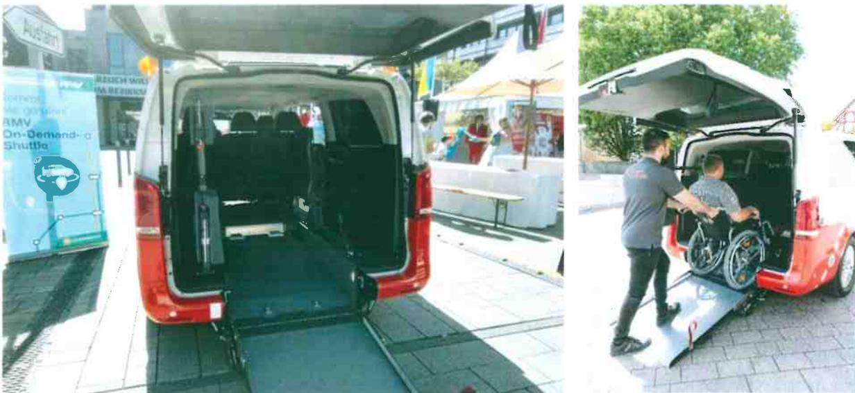
Abbildungen 33 und 34: Eines der acht Fahrzeuge ist für die Mitnahme von Rollstühlen und Kinderwagen geeignet
