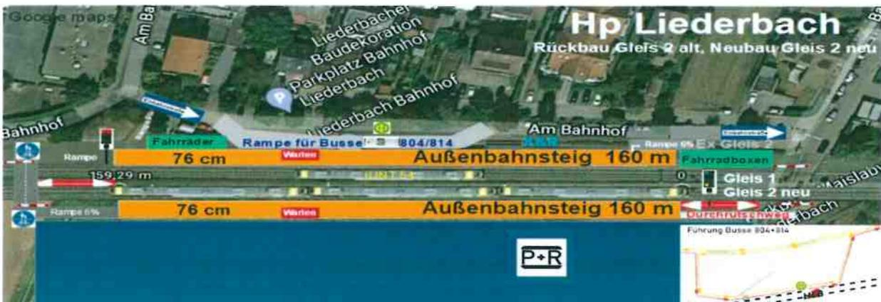
Der Haltepunkt Liederbach Süd kann nach Aufgabe der Niederlassung von Coca-Cola nunmehr nahezu problemlos komplett zweigleisig mit einem gegenüberliegenden oder einem versetzten Bahnsteig und – aus Sicherheitsgründen - einer videoüberwachten Vollschranke ausgeführt werden.
