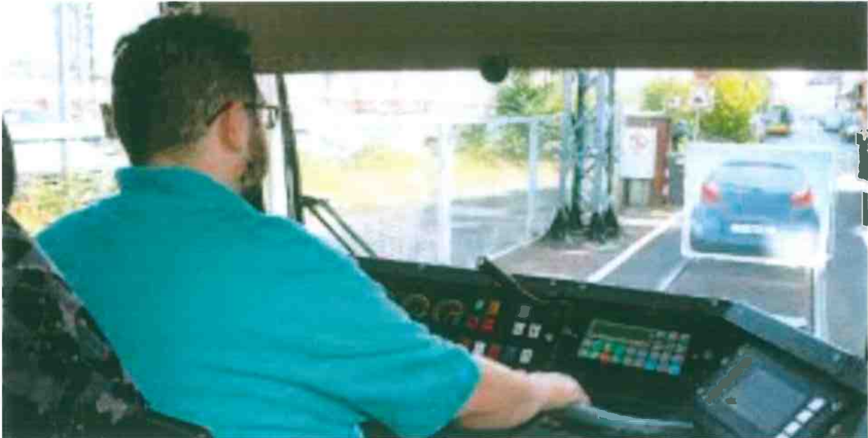
Abbildung 22: Wie alle neue Bahnen der VGF ist auch der T-Wagen mit FAS (Fahrerassistenzsystem) ausgerüstet
