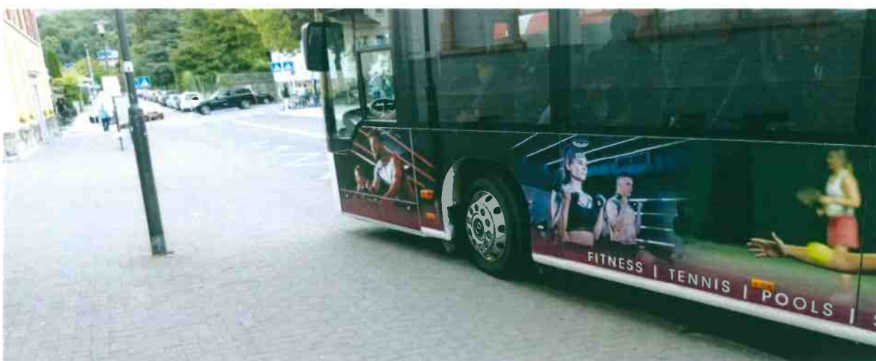
Abbildung 13: Ein zu dicht aufgefahrener Bus gerät beim Ausscheren zwangsläufig auf den Bürgersteig.
