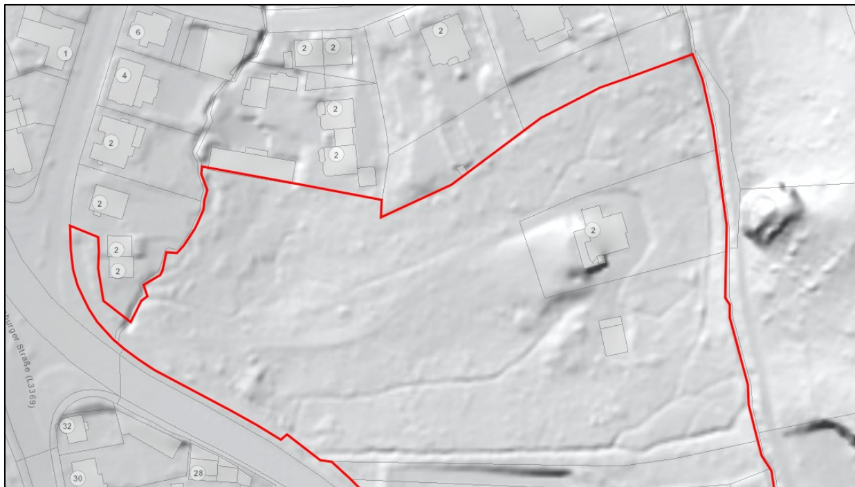
Abbildung 16: Geländeschummerung des nördlichen Plangebietsbereiches (rot). Hierdurch werden die vielen Gräbenverläufe sichtbar sowie die Senke im Nordwesten. Quelle: http://wrrl.hessen.de , HLNUG 2020C, eigene Bearbeitung 05/20.
