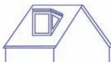
Fertiggaube mit verglasten Wangen
