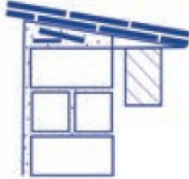
Bieberschwanz: eingemörtelte Ortgangziegel
