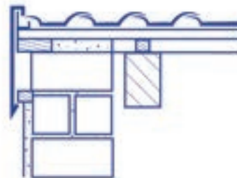
Ortgangabschluß mit Blechabkantung/Formteil
