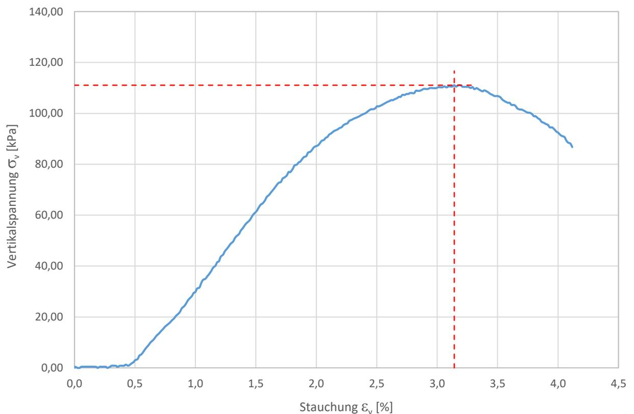
**Einaxialer Druckversuch** nach DIN EN ISO 17892-7
