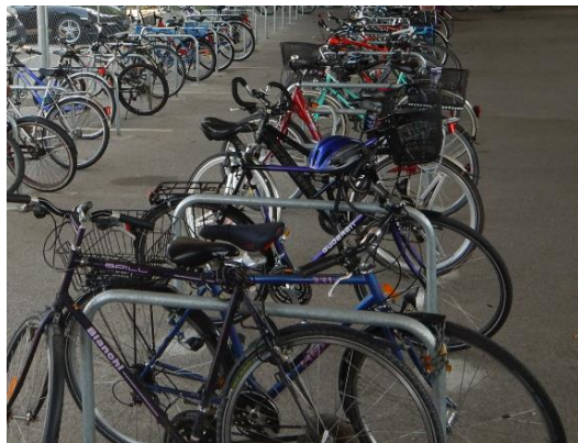
Abbildung 1: Typ Anlehnbügel (geeignet)
