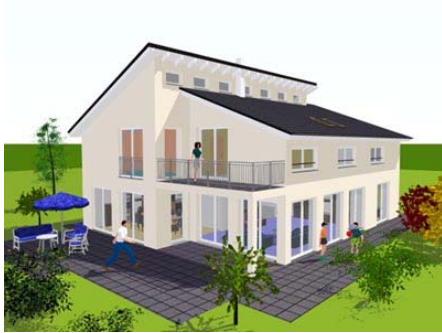
Abb. 1: Beispiel versetztes Pultdach
