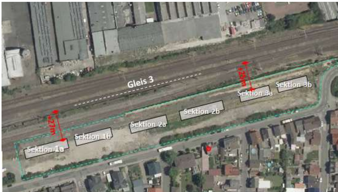
Abbildung 9: Abstände der Gebäudesektionen in Bezug zu Gleis 3
