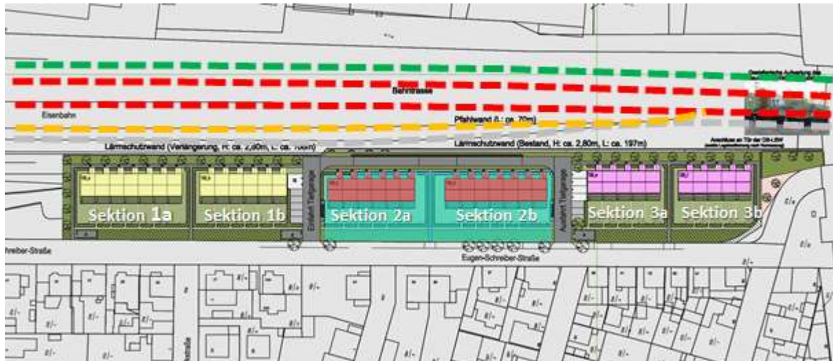
Abbildung 3: Geplante Bebauung in Lampertheim – die Sektionen 1 und 3 werden ohne Unterkellerung erstellt, die Sektionen 2a 2b werden auf der Decke einer Tiefgarage errichtet [5]
