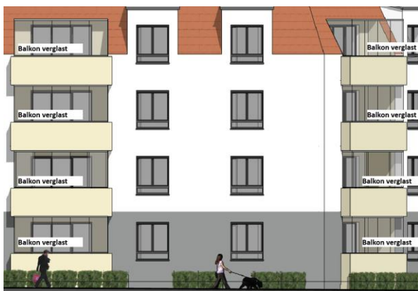
Abbildung 14: Schematische Darstellung Schallschutzkonzept (Stand 03/2022) 19
