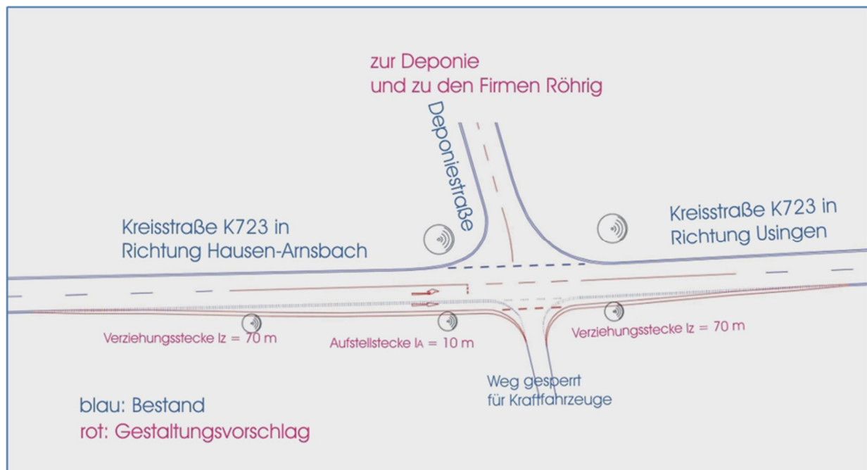
Abbildung 1: Gestaltungsvorschlag für den Anschlussknotenpunkt der Deponiestraße an die K723 (aus der Verkehrsuntersuchung zum Anschluss der geplanten Bebauung „Firmen Röhrig“ über die Deponiestraße an die K723“ vom 25. März 2019 (Fischer-Schlemm))
