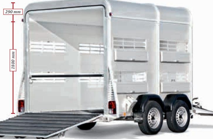
VA 3520 P Eloxiertes Aluminium-Aufbau mit Polyesterhaube und umlaufenden Stahlprofilstreben; Zubehör: Entladeklappe und Lüftungsklappen
