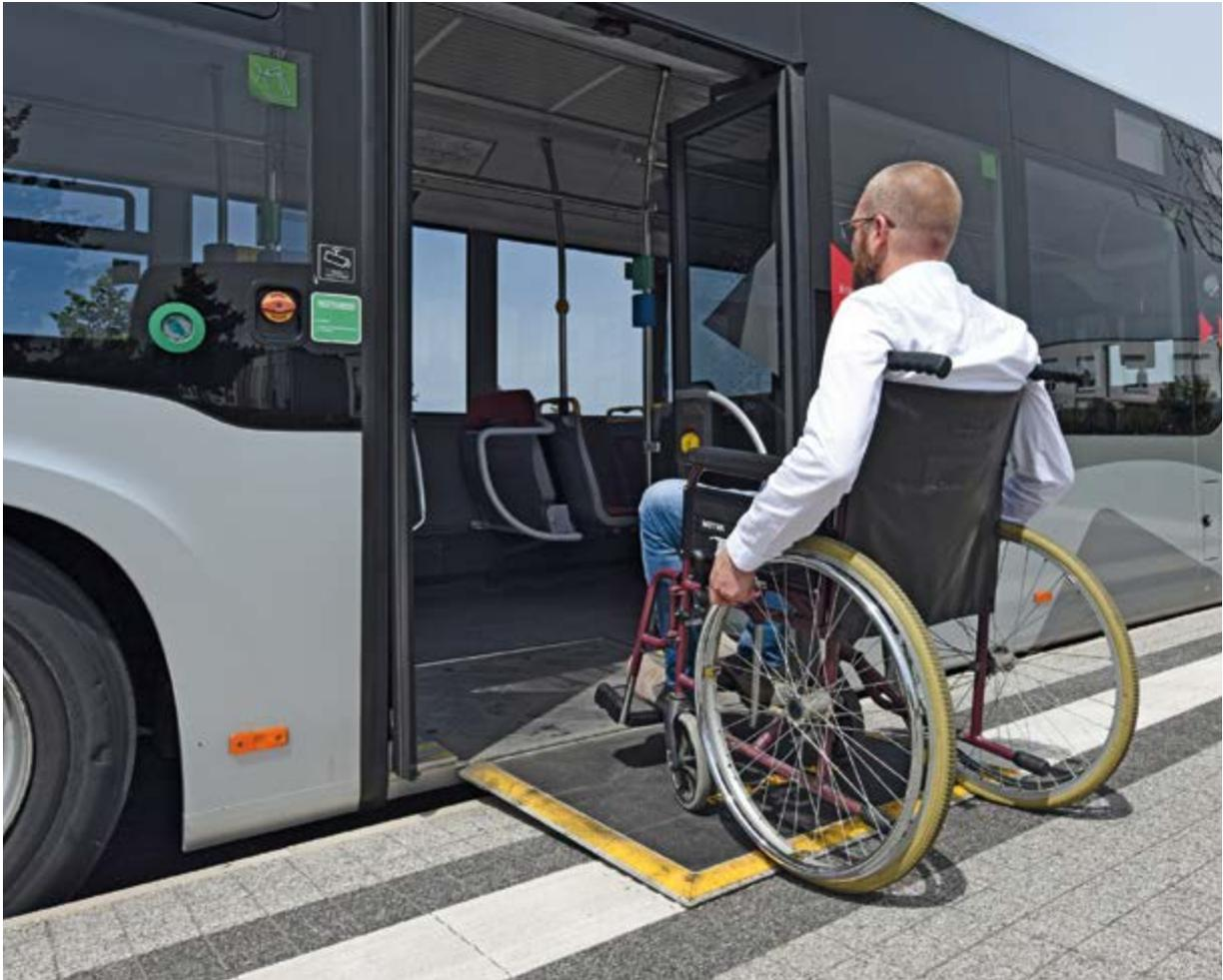
Abb. 11: Bus mit Klapprampe
