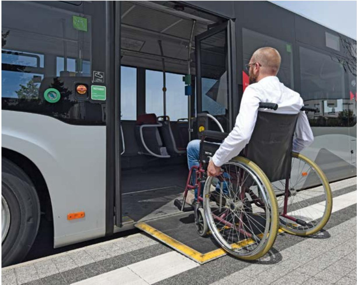
Abb. 11: Bus mit Klapprampe
