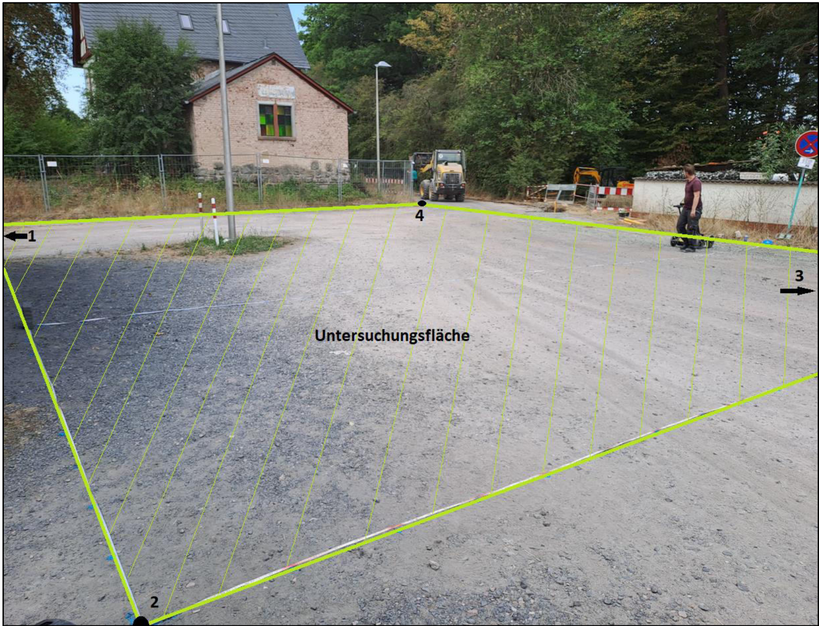
1: Übersicht Untersuchungsfläche VF-001 mit Rastereckpunkten, Georadarmessung
