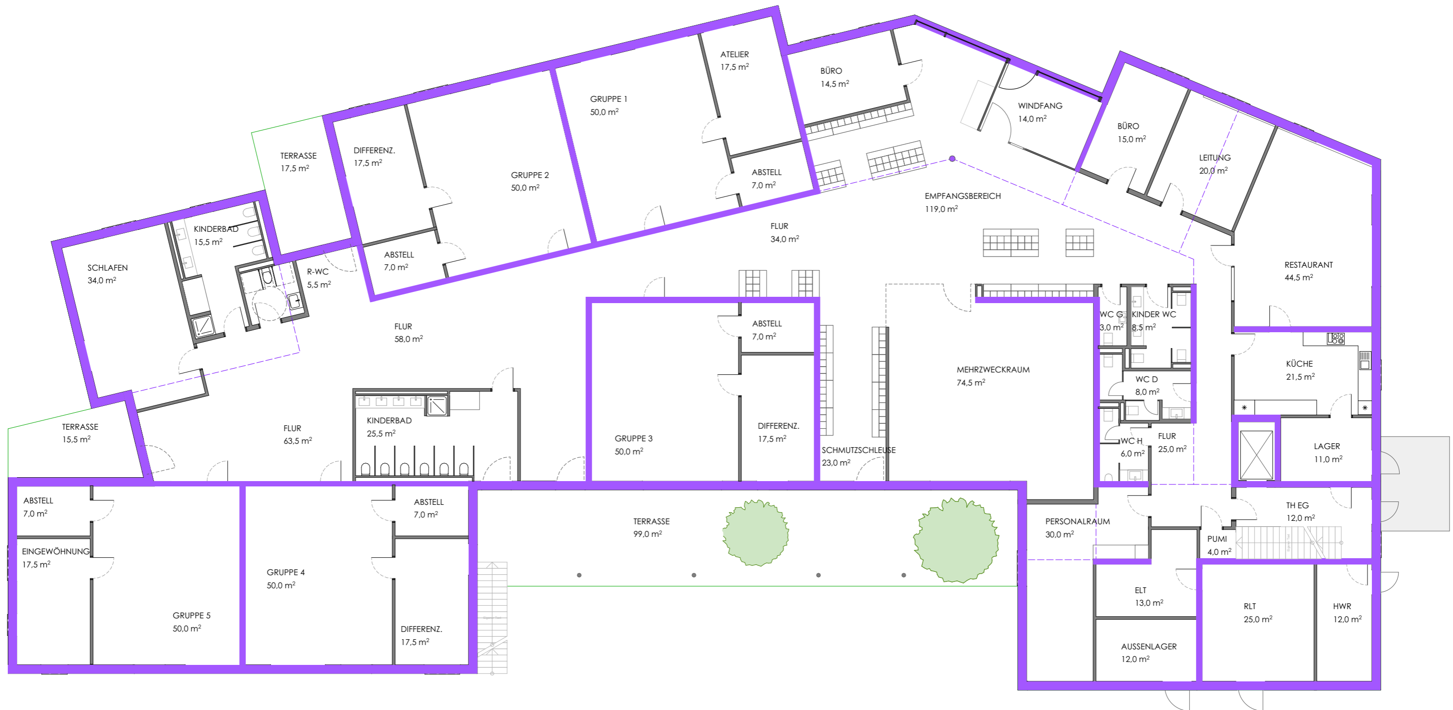
Grundriss Kita Vorschlag - EG tragende Wände
